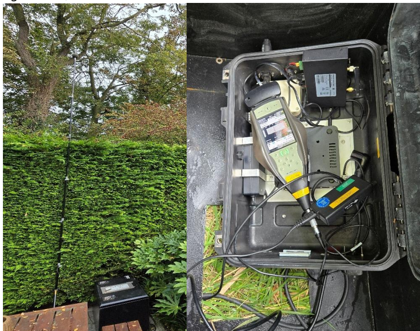
f 3.3 Meetpositie Groot Barlaken; links, meetopstelling met standaard en meetbol en rechts: meetapparatuur
